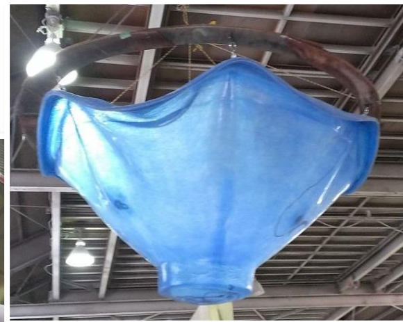
上：吊り具を改良し、形状維持してリフトアップ。 1名態勢での作業が可能に。 右下：製品端部の樹脂流動記録。約20分で含浸完了。
